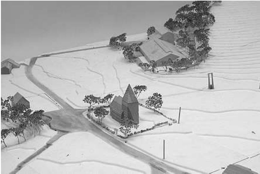
Figur 51: I arbeidet med en bedre tilpasning av det nye samdriftsfjøsset til det verdifulle kulturmiljøet ble det bygget modell av landskap og bygninger. Modell og foto: Arkitektfirma Jon Vikøren
