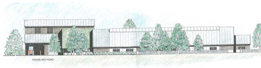
Figur 53: Fasadetegninger før og etter planene ble omarbeidet. Det er arbeidet med å bryte opp volumet ved bruk av ulike materialer og farger, og med terrengarronding og beplantning. For å bryte opp den store gavlfasaden mot vest (mot kirken) ble et mindre tilbygg lagt her. Mindre takflater ble trukket ned ved hovedinngangen mot øst. Tegninger: Fylkesmannen i Sogn og Fjordane og Arkitektfirma Jon Vikøren/ Landskapsarkitekt Valborg Leivestad.
