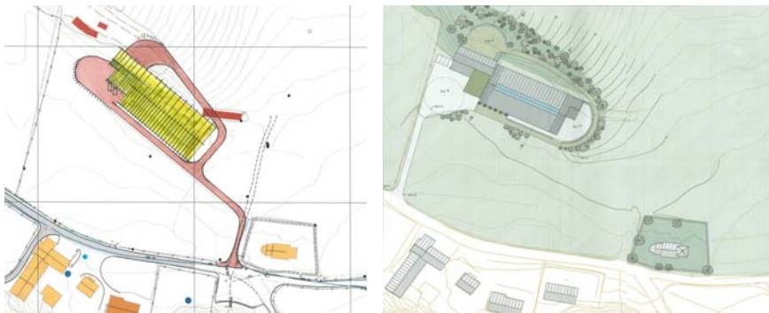
Figur 52: Plantegninger før og etter at planene ble omarbeidet. Fjøsset er trukket lenger unna middelalderkirken og lagt mer inn i terrenget. Tegninger: Fylkesmannen i Sogn og Fjordane og Arkitektfirma Jon Vikøren / Landskapsarkitekt Valborg Leivestad
