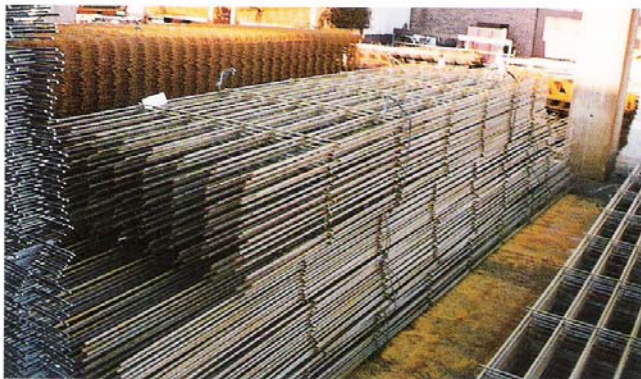
Exempel på monteringsvetsad armeringsbeter.
