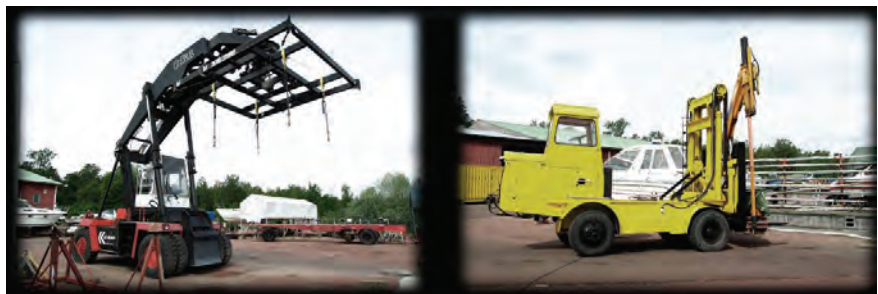
Mynd 25. Trukkur at draga bátar við og trukkur at arbeiða upp á mastrar við á sleipistöð Á 3.
