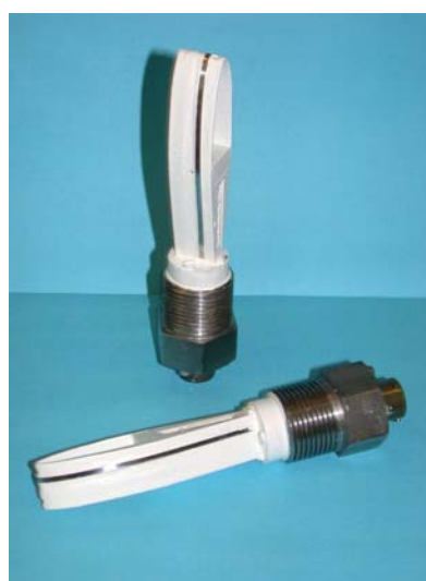
Fig. 4.2.28. ER probe. (MetriCorr).
